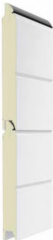
Für höhere Ansprüche, vor allem, wenn Garagen direkt ans Haus anschließen, bietet der Hersteller das Energiespartor LPU 67 Thermo an. Dieses erreicht mit thermisch getrennten, 67 mm starken Lamellen eine besonders gute Wärmedämmung mit einem U-Wert von bis zu  $0,33 \text{ W}/(\text{m}^2\text{K})$ . Zusätzlich kann ein sogenannter Thermo-Frame eingesetzt werden, der die Wärmedämmung um bis zu weitere 15 % verbessert.
